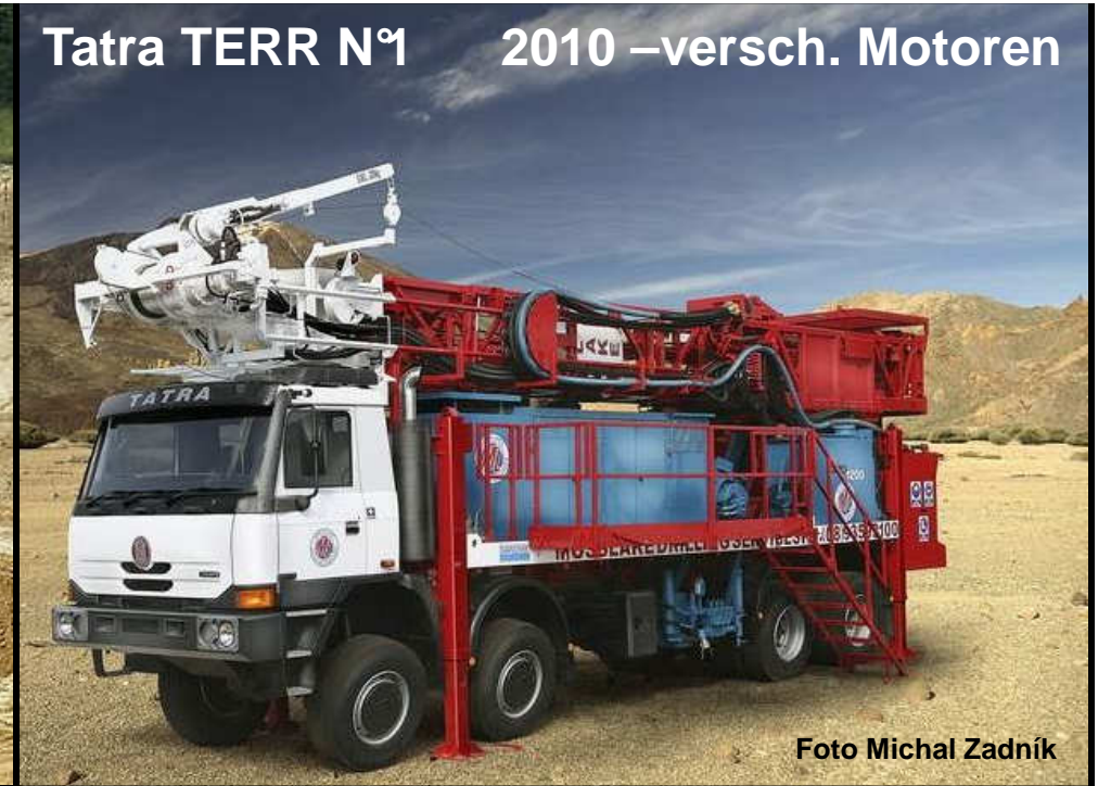
6 Zyl. PACCAR MX, 265 bis 375 kW, Kabine ist v. DAF CF 85.
