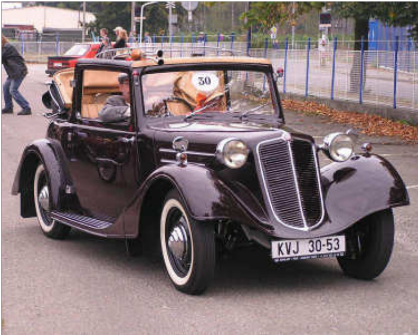
T 85 1936–41 wassergekühlt 4 Zyl. 8143 cm 3 , max. rychlost: 60 km/h, verbrauch: 45-50 l/100 km, Hi-Antrieb, Last 5 - 6 t
