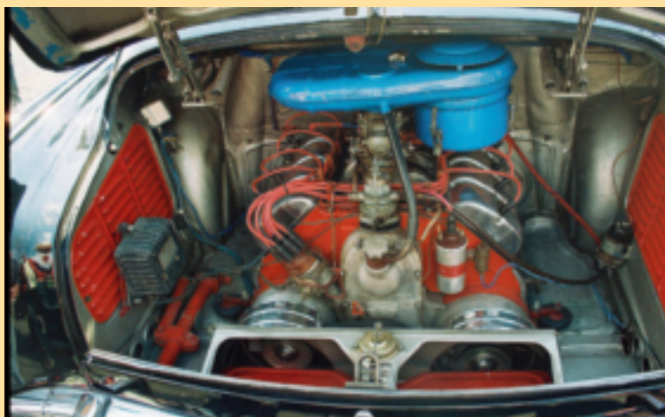
Avantgarde: Einen luftgekühlten V8 mit 2,5 Litern Hubraum im Heck einer Oberklasse-Limousine, das gibt es in keinem anderen Auto der Welt.
