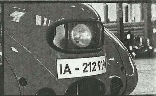
Aus aerodynamischen Gründen sitzt die Frontleuchte hinter einer Scheibe
