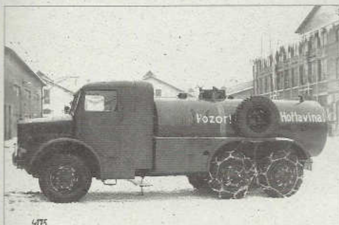
Palivová cisterna na podvozku T 85 (1937)
