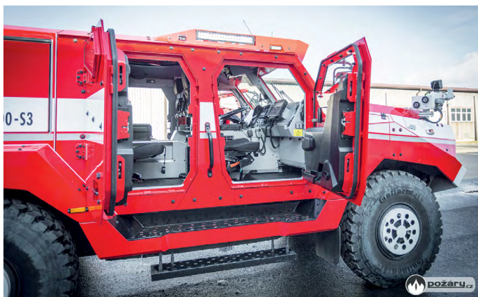
Kabina osádky je čtyřmístná a uprůsobená pro průjezd hustým lesním porostem.
