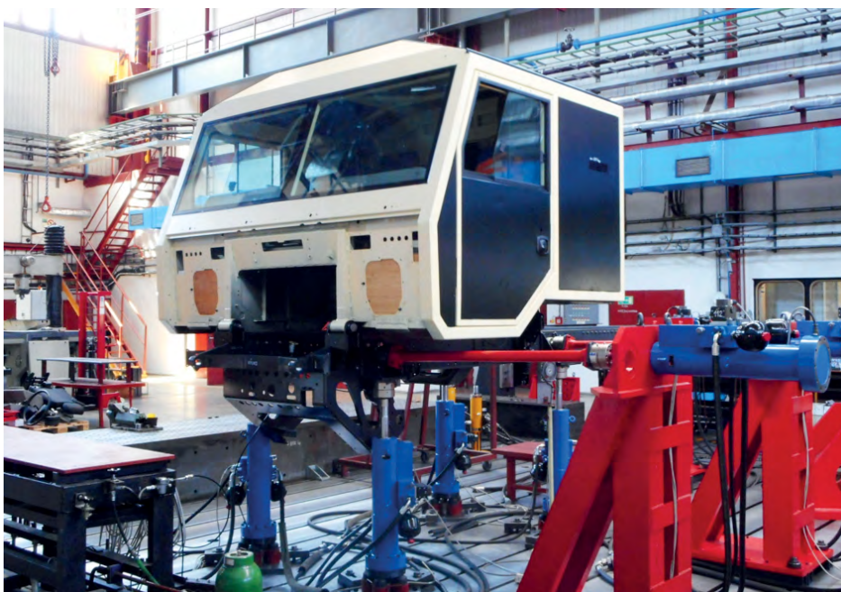
Zkouška kabiny T810 TACTIC na zkušebním stavu.
