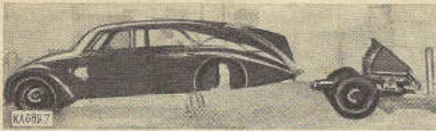
Bild 7. Nach Lösen weniger Schrauben kann der gesamte Triebsatz wie hier beim Achtzylinder gezeigt, einschließlich der Räder ausgefahren werden
