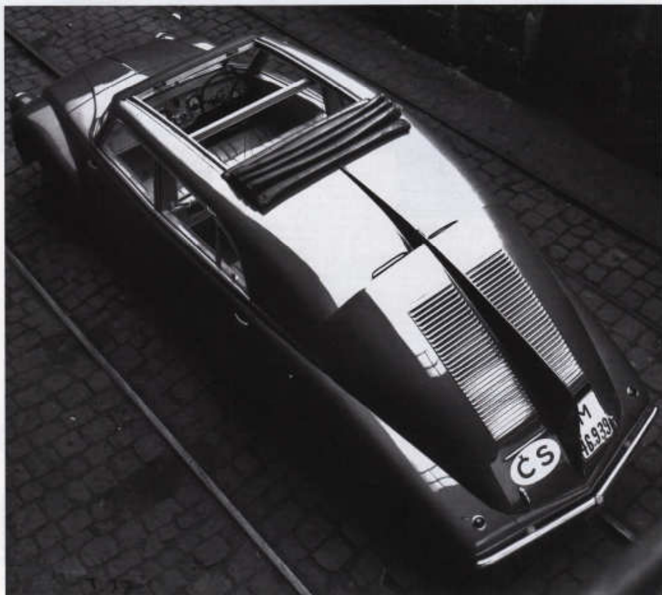
T 77, die zweite Serie mit Webasto-Dach und Trennwand zum Chauffeur.
