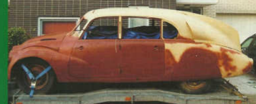
Aangeboden als gerestaureerd en met gereviseerde motor... Dat laatste klopte wel. De carrosserie bleek bij nadere inspectie iets getordeerd te zijn.
