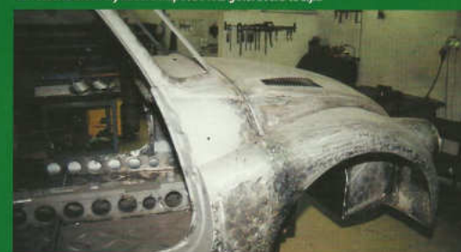
Veel nieuw plaatwerk en dus een hoop laswerk. Voor de restauratie nam Kees Smit een Tsjechische specialist in de arm die al diverse T-87's onder handen genomen had.
