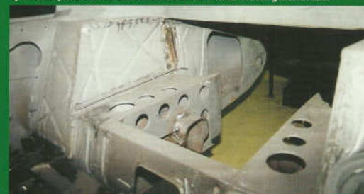
Tussen de kokerbalken komt de versnellingsbak, met daarachter de V8. Boven de versnellingsbak zit een plateau waar bagage gestouwd kan worden.
