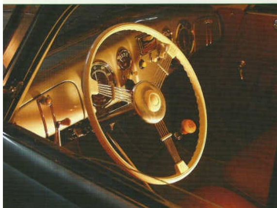
In deze T-87 uit 1939 horen instrumenten met zwarte wijzerplaten te zitten, dus werden speciaal voor deze auto nieuwe wijzerplaten gemaakt.
