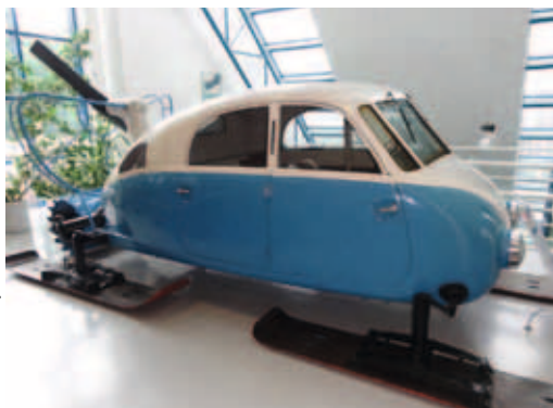
▲ Kuriozní aerosaně Tatra V855, upravené z vozu T87 s tlačnou dvoulistou vrtulí a mechanicky zdvihaným tlačným třírychlostním bubnem (prototyp 1942; repliku postavila firma Ecorra v roce 2008 pro Lane Motor Museum v Nashville)
