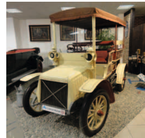
▲ NW typ B Viceprezident, jeden z prvních typů s dvouválcem 3.2/8,8 kW (12 k), se v Kopřivnici vyráběl v letech 1901–1904
