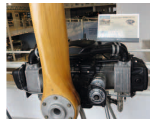
▼ Letecký motor Tatra AT714, čtyřválcový boxer odvozený z T613, poháněl letoun XL-113, variantu kluzáku L-13 Blaník (1986)
