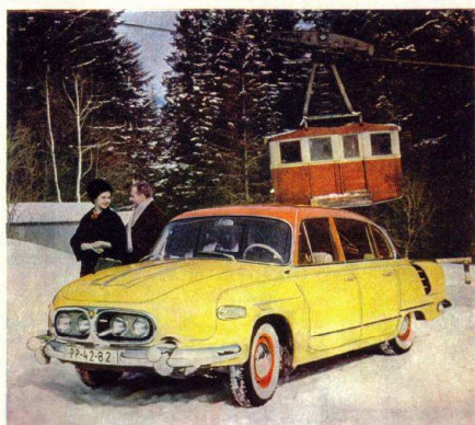
Osobní automobil TATRA 2 - 603, zlepšený model původního typu TATRA 603 dosahuje se svým vzduchem chlazeným, vřadit motorem typu TATRA 603 H o výkonu 105 ks maximální rychlosti 160 km/h, při vynikajících jízdních vlastnostech a velmi ekonomickém provozu: spotřeba paliva je jen 12,5 l/100 km při rychlosti 105 km/hod. Dále má nový typ TATRA 2 - 603 například tato zlepšení: Nové, obdélné a moderně vyřešené přístrojové desky, čtyři světlomety, nové provedení zadních světel a stabilizátor přední nápravy.
