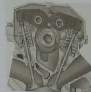
33 Motorquerschnitt Typ II Detail Steuerung
