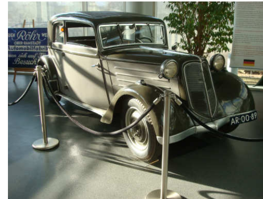
RÖHRL – JUNIOR Mod. 1933 Die Frankfurter Detra-Werke lizenzieren im Jahr 1933 den Röhrl-Werken den Tatra 75. Dieser wurde dann in leicht abgewandelter Form als Röhrl- Junior gebaut. Luftgekühlter 4-Zyl. Boxermotor Nockenwellensteuerung mittels Stirnräder. Batteriezündung , Bosch 6 Volt
