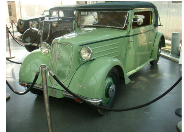
RÖHRL – JUNIOR Mod. 1933 Die Frankfurter Detra-Werke lizenzieren im Jahr 1933 den Röhrl-Werken den Tatra 75. Dieser wurde dann in leicht abgewandelter Form als Röhrl- Junior gebaut. Luftgekühlter 4-Zyl. Boxermotor Nockenwellensteuerung mittels Stirnräder. Batteriezündung , Bosch 6 Volt
