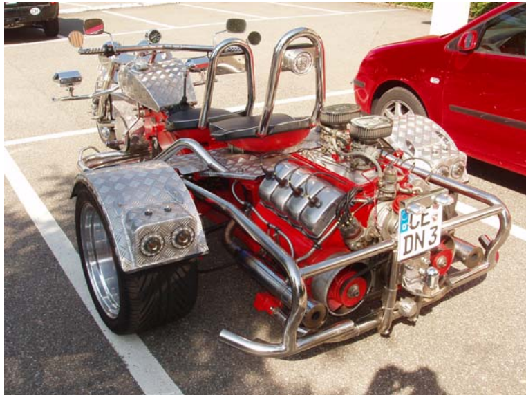
Eine besondere Bereicherung unseres Treffens war der Trike Eigenbau mit Tatra 603 Motor von Heinz und Karin Schönrock aus Deutschland
