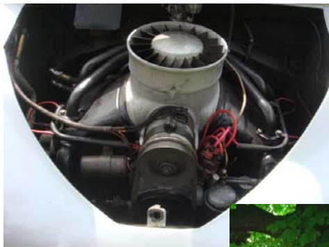
Ansicht des Motors von Ernst Bieber's Tatra-Plan. Dieses Baumuster mit einem horizontalen Kühlluft-Gebläse wurde nur beim Baujahr 1948 verwendet.
