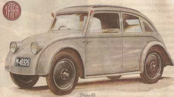
Tatra V 570: 1933 entwickelter Kleinwagen mit einer Höchstgeschwindigkeit von 75 km/h
