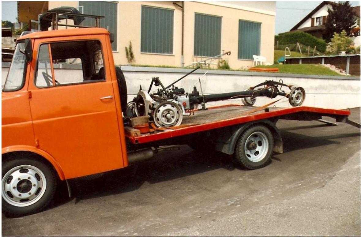
Abbildung 27: Chassis komplet das ging später mit allen anderen Teilen nach Kopvrinice wo es von Tatra Spezialisten fertig gemacht wurde, Das heisst 9 Man ein Jahr ca 11000 Arbeitsstunden in der CZ.
