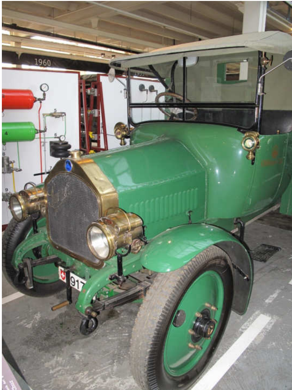
1917 3 TC 4Zyl. 5 L, Nutzlast 3 T Geschw. 25KM/H, Pat. Motorbremse
