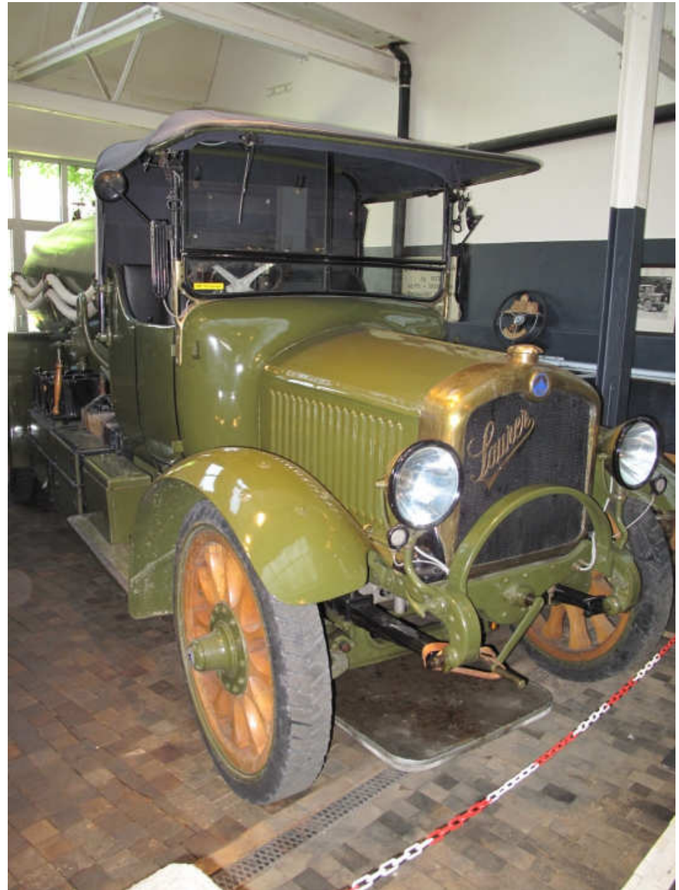
1923 Tankwagen der Fliegertruppen, 6.8L 4 Zyl. 40 PS Vollgummireifen Holzspeichen
