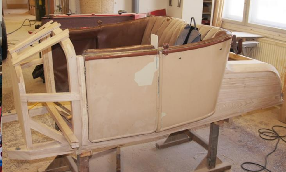
UNIC – výdřeva částí karoserie v rámci renovace a konečný výsledek
