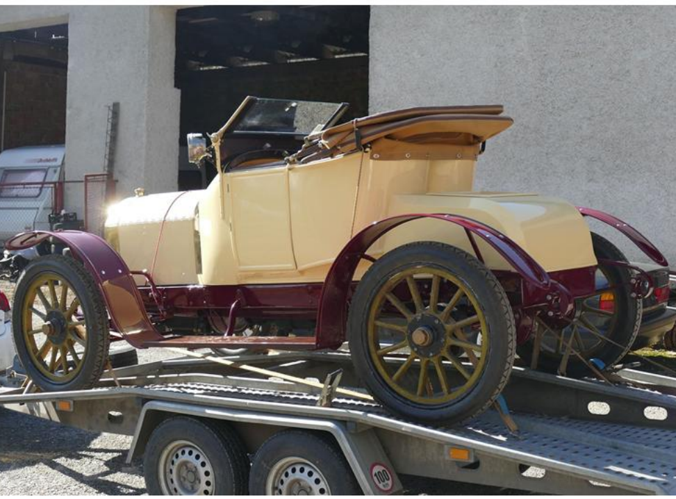
UNIC – výdřeva částí karoserie v rámci renovace a konečný výsledek
