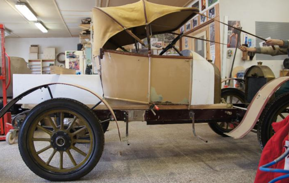
UNIC – výdřeva částí karoserie v rámci renovace a konečný výsledek
