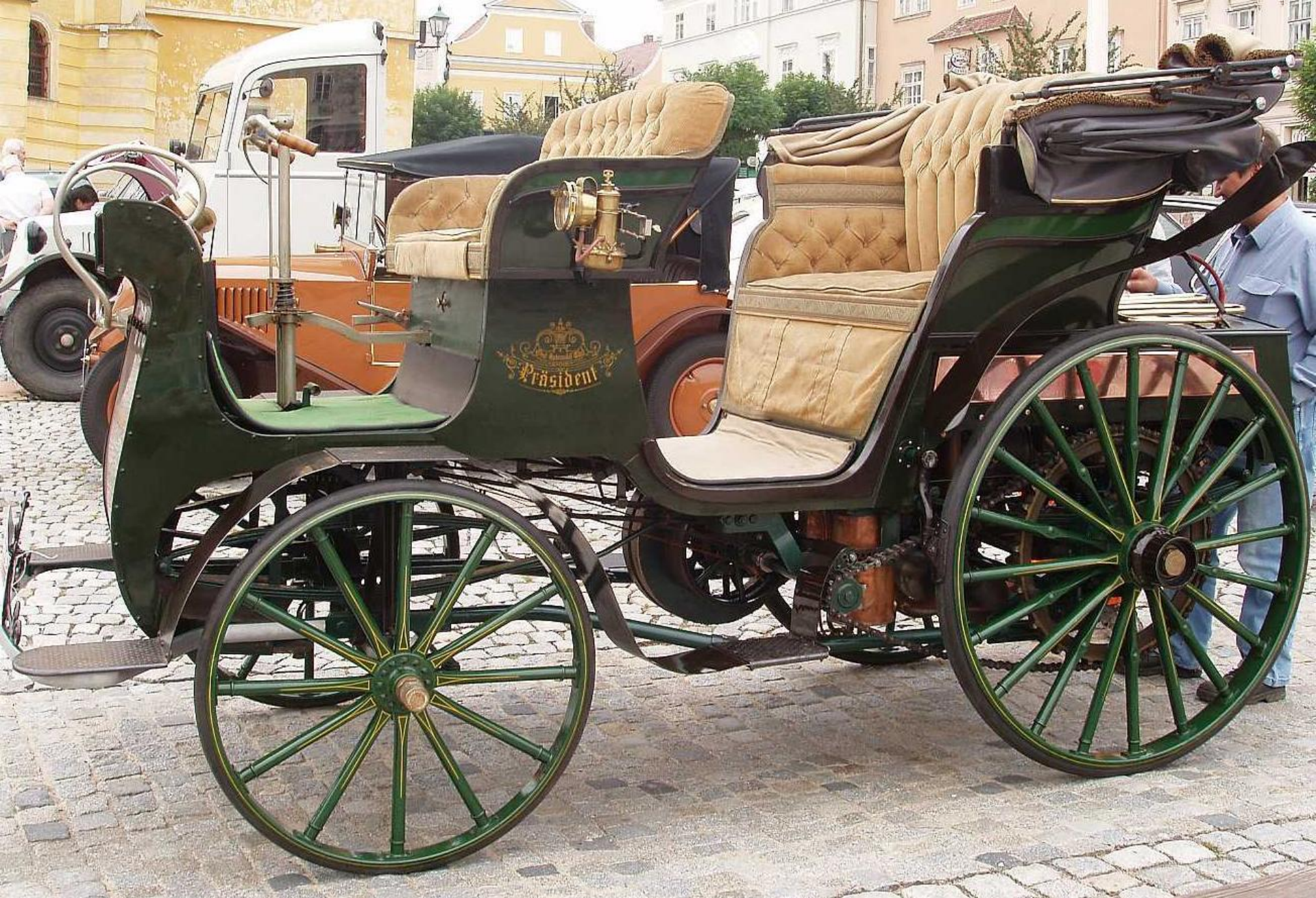
NW 1 Präsident – eine motorisierte Kutsche mit Daimlermotor
