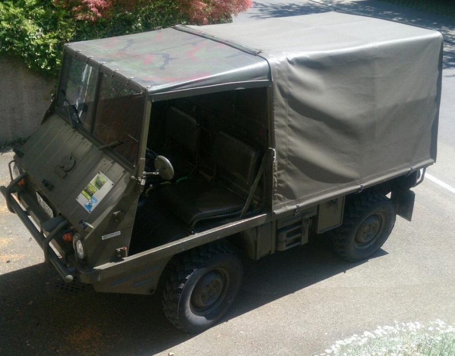
Schweizer Armee, Haflinger, 4 x 4, 2 Differentialsperren, Konstrukteur Erich Ledwinka
